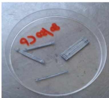
Fibre anticorrosione, prova superata
