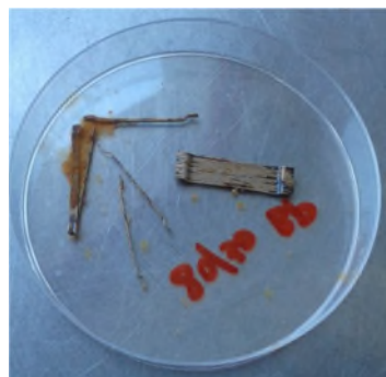
Fibre corrodibili, prova non superata
