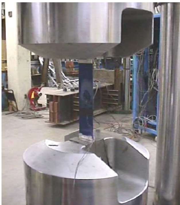
Esecuzione del test secondo ASTM D3039
